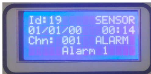
Figura 24) Dettagli evento di Allarme 1
